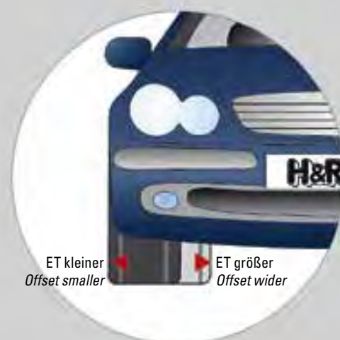
Mit TRAK+ ® TM Spurverbreiterungssystem Spurweite (ET +18) Fitted with TRAK+ ® TM Spacers (offset +18)
