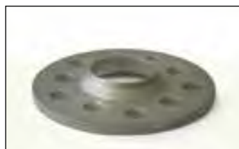
Artikel-Nr. / Part-no. 1655572: Radnabenlänge max. 14 mm. Felgeninnenfase mind. 7x45° Wheel hub length max. 14 mm. Inner bavel 7x45°
