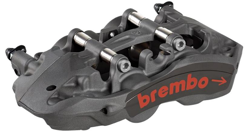
4 pistoni, 28/30 - 36/42 mm (1.10/1.18" - 1.41/1.65"), adatta a dischi con diametro da 315 - 330 mm (12.40" - 12.99") e spessore 28 mm (1.10").
