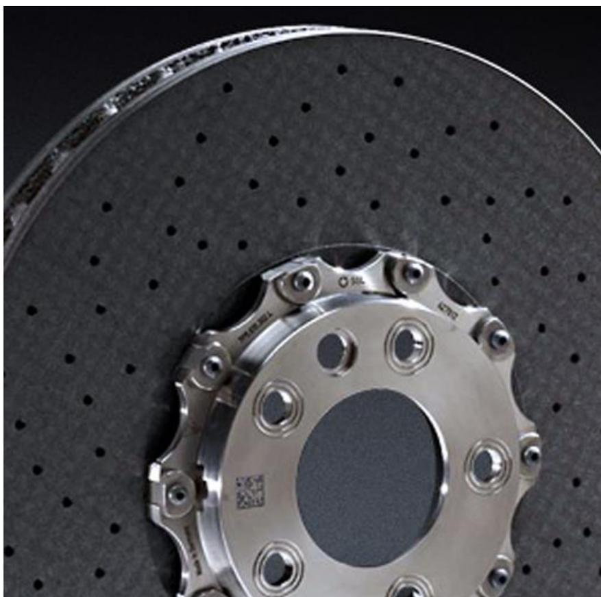
La densità del carbonio è di 1,7 grammi al centimetro cubo, a differenza dei 7,8 grammi dell'acciaio e dei 7,3 grammi della ghisa grigia. Il suo coefficiente di espansione termica è un quindicesimo dell'acciaio e un undicesimo della ghisa. Il punto di fusione del carbonio è superiore ai 3.000°C a fronte dei 1.200°C della ghisa e dei 1.800°C dell'acciaio.
