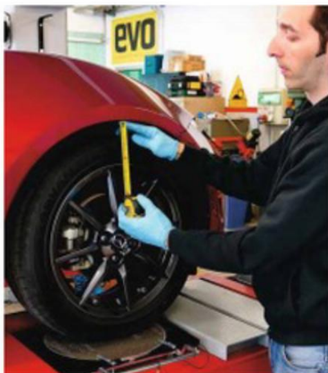
Sopra: l'installazione del kit Motorquality richiede circa 4 ore di lavoro, senza modificare nulla e con la possibilità di tornare in qualsiasi momento al set up originale Sotto: la differenza di altezza dopo il montaggio del kit è visibile anche a occhio, ma per la precisione l'abbassamento è di 4 cm sia all'anteriore sia al posteriore
