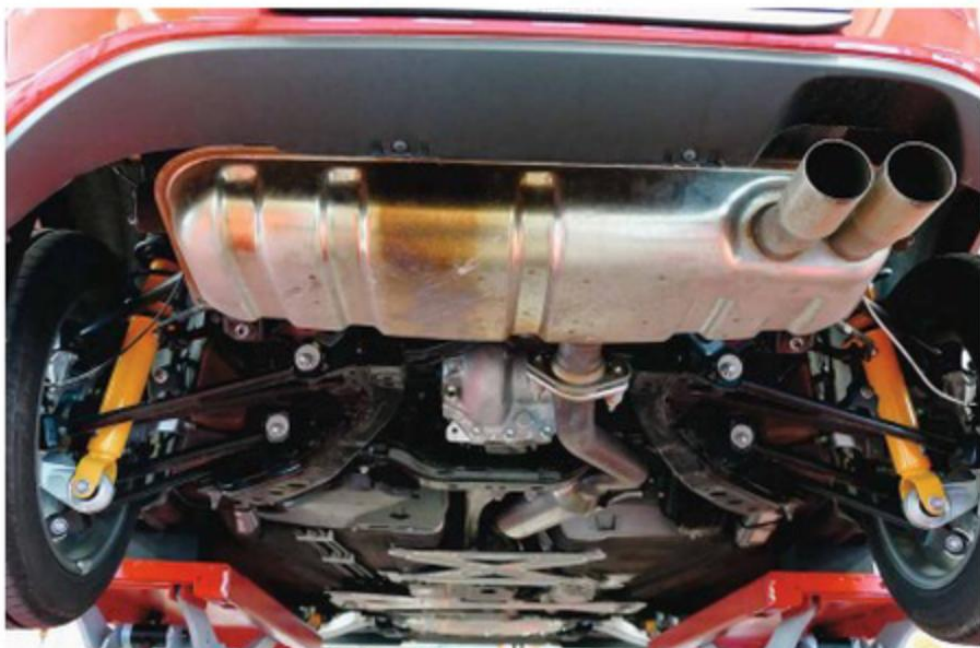
Sopra: l'installazione del kit Motorquality richiede circa 4 ore di lavoro, senza modificare nulla e con la possibilità di tornare in qualsiasi momento al set up originale Sotto: la differenza di altezza dopo il montaggio del kit è visibile anche a occhio, ma per la precisione l'abbassamento è di 4 cm sia all'anteriore sia al posteriore
